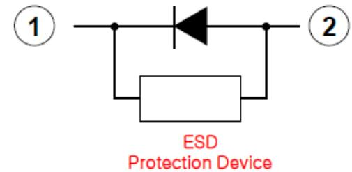
※UV LEDベアチップに並列で小型チップが接続されている。静電気防止ツエナーダイオードである。
