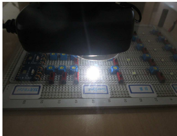
写真-5 個別LED測定
